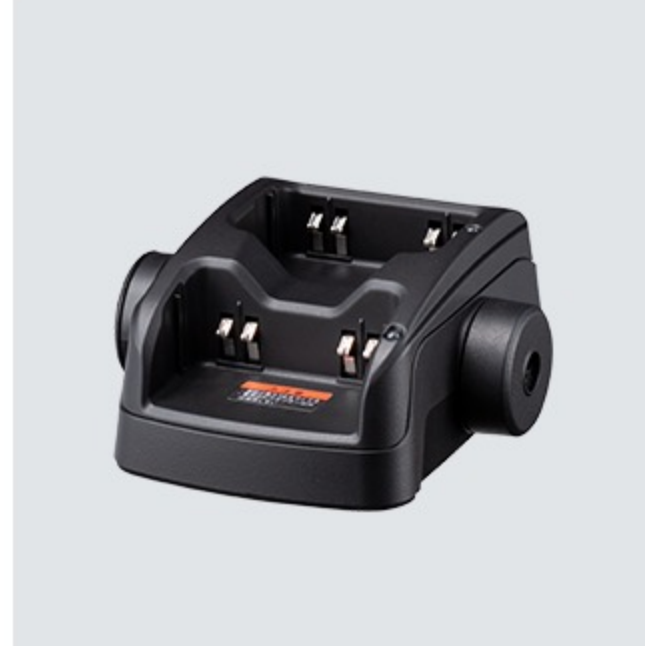
連結型充電器 SBH-30 ・2台同時充電が可能 ・最大3連結(6台同時充電)に対応 ・ACアダプタSAD-50Aが必要です
